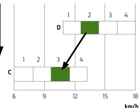
Speedmatch (uskladijanje brzine) osigurava da kada mijenjate raspon mjenjačem Powr8™ ili PowerQuad™, mjenjač uvek odabire najbolji stupanj prijenosa koji odgovara brzini traktora prema naprijed.
