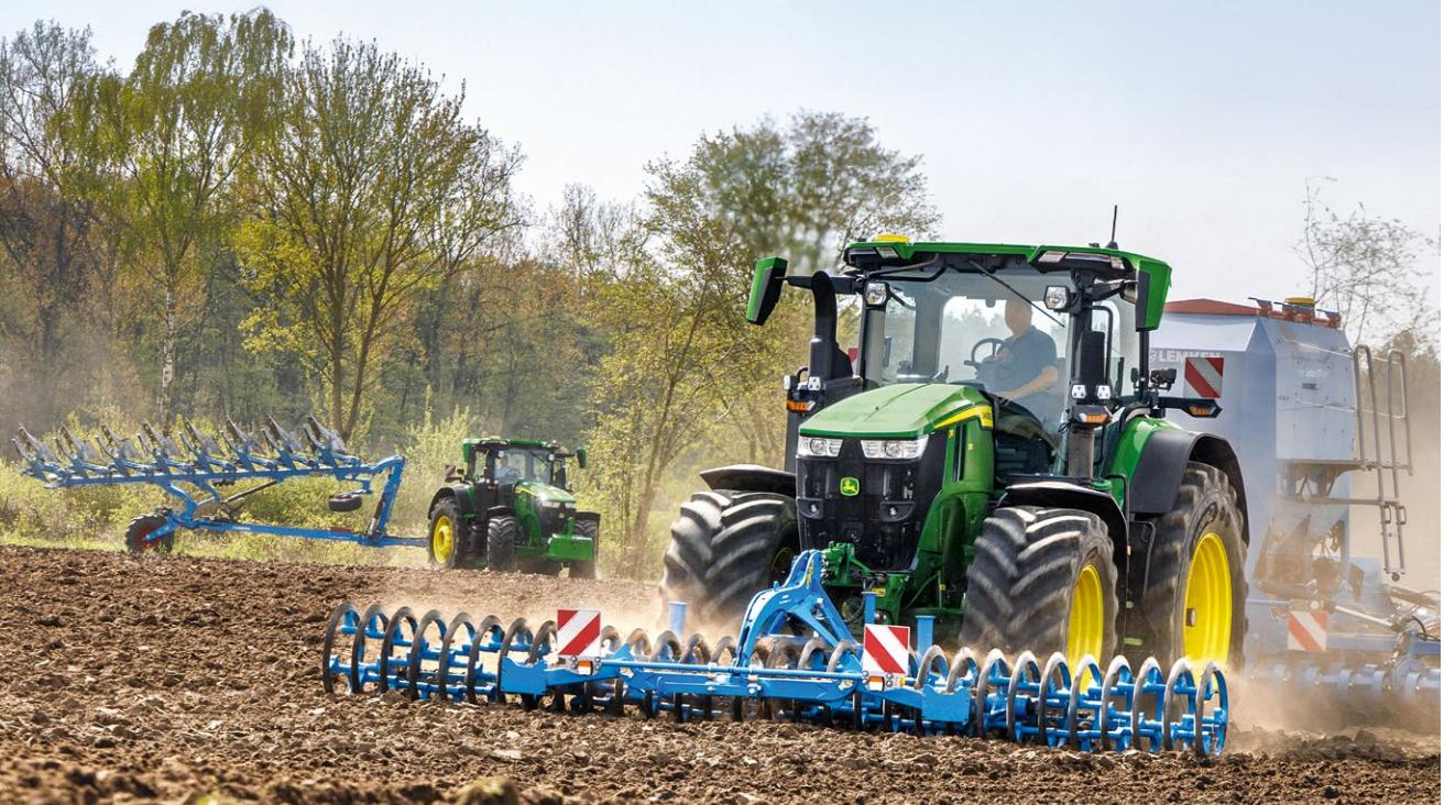
Opcionalno na raspolaganju, iTEC™ kompatibilna prednja podizna poluga ima maksimalni kapacitet dizanja od 3.500 kg na kukama.
