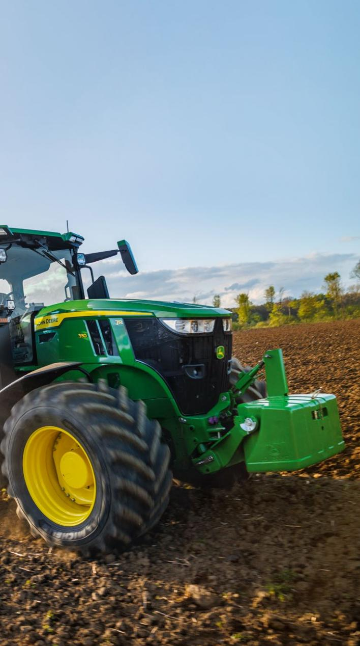
Najbolje performanse na polju – deset brzina u glavnom radnom rasponu od 5 do 16 km/h daju idealnu brzinu za najzahtjevije vučne primjene.
