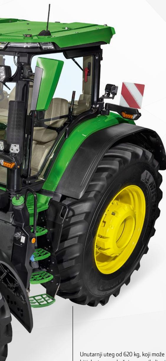
Unutarnji uteg od 620 kg, koji može biti dostupan s kočnicama prikolice i dodatnim spremnikom za uzimanje ulja.
